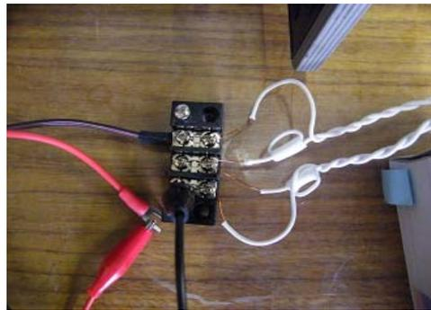
白チューブ同士を接続 後は両方の電線を電源に接続
