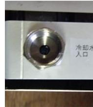
冷却水入口(循環装置 OUT)
