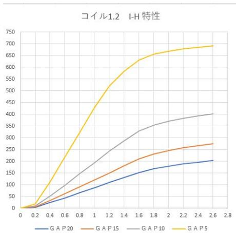
磁極間隔 20,15,10,5, (mm) 磁極チップ交換方式
